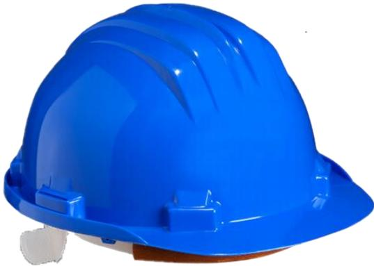
Capacete fabricado em polietileno de alta densidade por injeção. A sua superfície é lisa e apresenta duas nervuras paralelas no seu eixo longitudinal e uma nervura sólida de secção triangular, que conferem uma maior rigidez ao casco. No interior, existem seis suportes de arnês.
