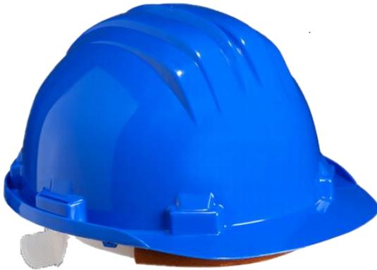
Casco fabricado con polietileno de alta densidad moldeado por inyección. Su superficie es lisa y presenta dos nervaduras paralelas en su eje longitudinal y una nervadura maciza de sección triangular, que confieren al casco una mayor rigidez. En la parte interior presenta seis alojamientos para fijar el arnés.
