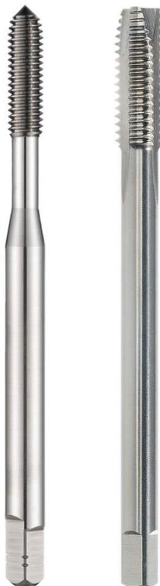
Os machos de máquina CHEMITOOL em aço rápido, fabricados de acordo com a norma DIN 371 e DIN 376 em forma B, são especialmente destinados a trabalhos exigentes, dado o seu encaixe reforçado com o intuito de fornecer ao utilizador um produto de boa qualidade com um rendimento de trabalho constante durante o processo de abertura de rosca.
