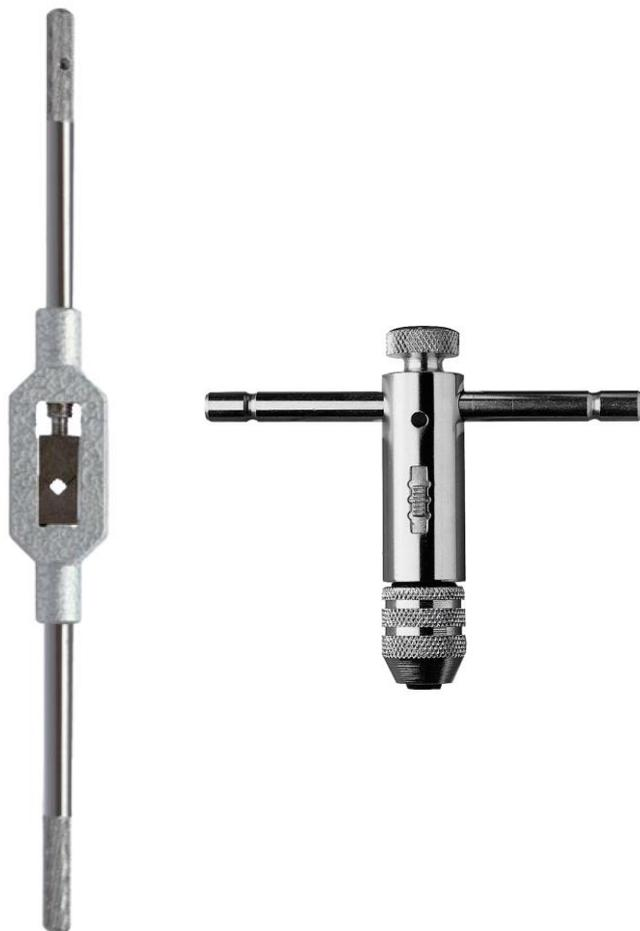
O desandador ajustável DIN1814 **CHEMITOOL** é indicado para processos de roscagem de machos de maior dimensão e em sítios de acessibilidade reduzida. Possui dois mordentes tensionadores quadrados, não permitindo que o macho se liberte facilmente. As em aço com ranhuras faz com que se adapte à mão e não deslize, sendo possível a remoção de uma pega para facilitar o acesso.
