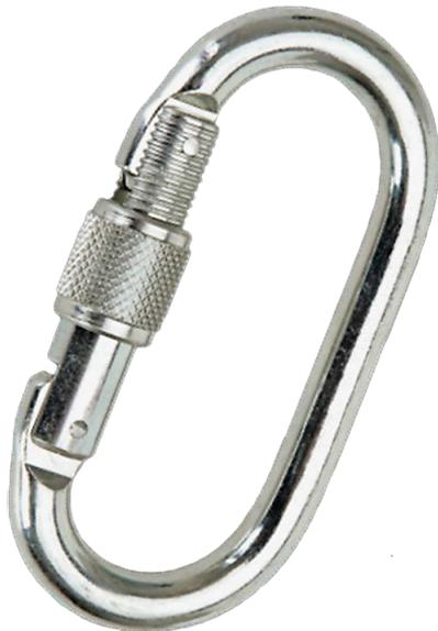
Mosquetón en Acero **CHEMITOOL** posee cierre automático mediante la acción del muelle resorte interior, y bloqueo manual mediante tuerca cilíndrica. Con este sistema se impide totalmente el desbloqueo involuntario o accidental del mosquetón. Todos los componentes del mosquetón, cuerpo, pieza de cierre, tuerca, resorte, trinquetes y pasadores, son de acero con excelentes propiedades mecánicas. Apta para uso en atmósferas potencialmente explosivas (ATEX).
