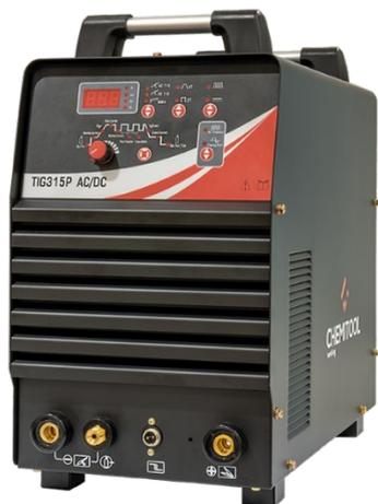
Aparelho de Soldar TIG315P CHEMITOOL com tecnologia inverter IGBT para soldadura MMA e TIG. Indicado para todos os materiais, proporcionando excelentes resultados de soldadura em corrente alternada (AC) para soldar para soldar alumínio e ligas leves, ou em corrente contínua (DC) para soldadura de aço ao carbono, inoxidáveis e outros metais ferrosos.
